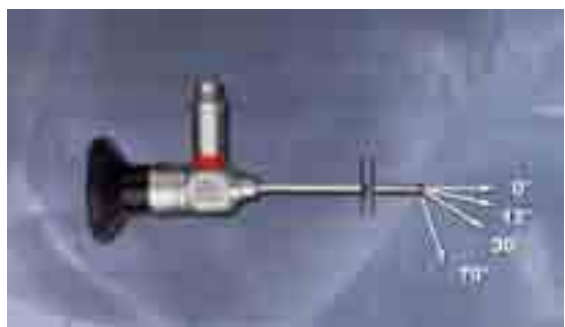
Fig. 9 Angolo di visione: corrisponde all'angolazione con cui osservo la cavità. È l'equivalente del concetto di forobliquità. Esistono ottiche con angolazioni visive da 0°, 12°, 30°, 70°
